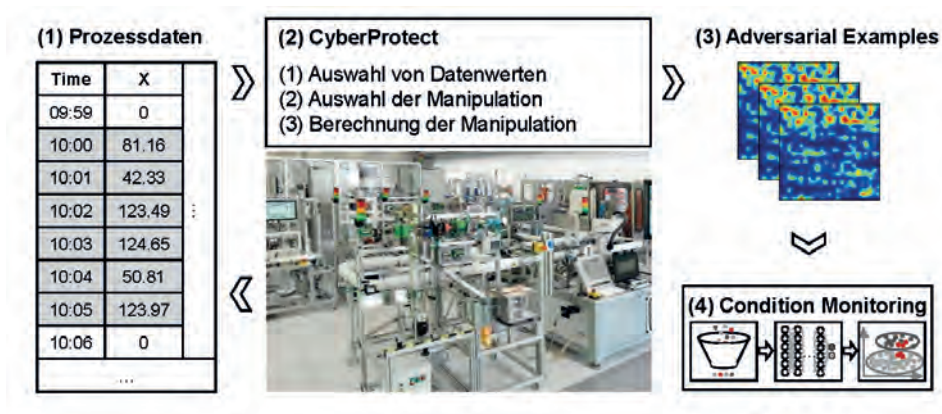
Abbildung 2: Die grundlegende Idee des CyberProtect-Lösungsansatzes.
