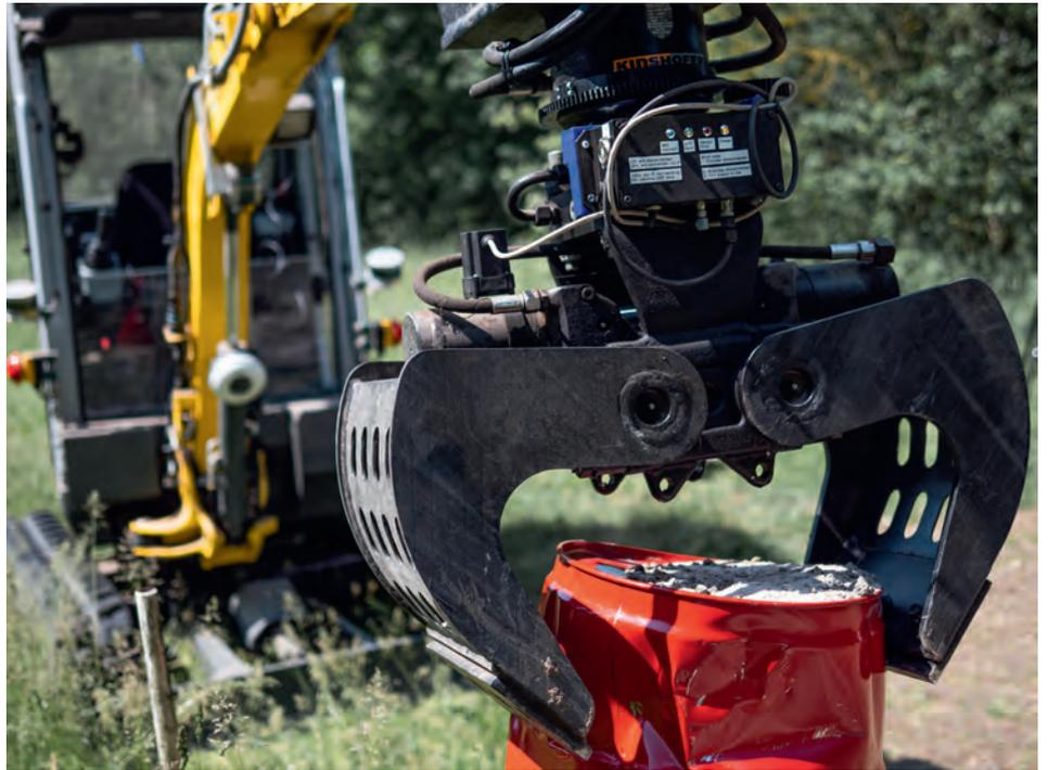
Abb. 1: Automatisierter Bagger IOSB.BoB beim Bergen eines Fasses.
