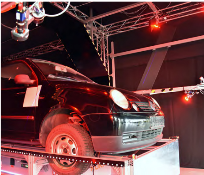
Abb. 2: 3D-Vermessung per Laserlinien-Triangulation. Anhand retroreflektierender Marker-Kugeln lokalisieren sich die Sensoren im Objekt-Koordinatensystem..
